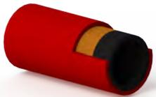
Tubo interno em borracha sintética especialmente desenvolvida resistente a altas temperaturas (RMA CLASSE B) reforçado com uma tela têxtil de alta resistência coberta por borracha sintética resistente à abrasão, a hidrocarbonetos e ozono. Não é necessária a utilização de abraçadeiras.
