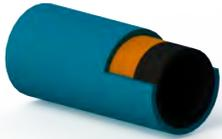
Tubo interno em borracha sintética resistente a óleos (RMA CLASSE B) reforçado com uma tela têxtil de alta resistência coberta por borracha sintética resistente à abrasão, a hidrocarbonetos e ozono. Não é necessária a utilização de abraçadeiras.
